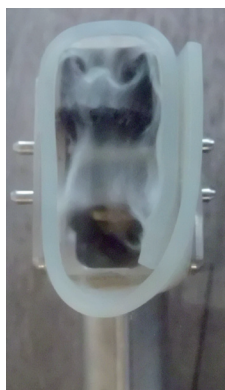
Visualização da cabeça de injeção/extração através de um vidro
